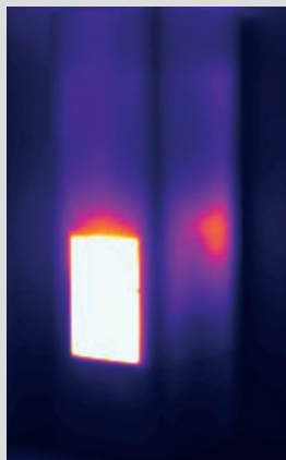
1 hod. od zakúrenia ~ teplota povrchu 29 °C
