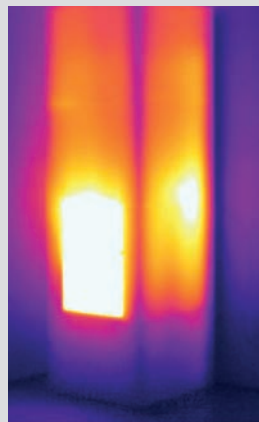
3 hod. od zakúrenia ~ teplota povrchu 88 °C
